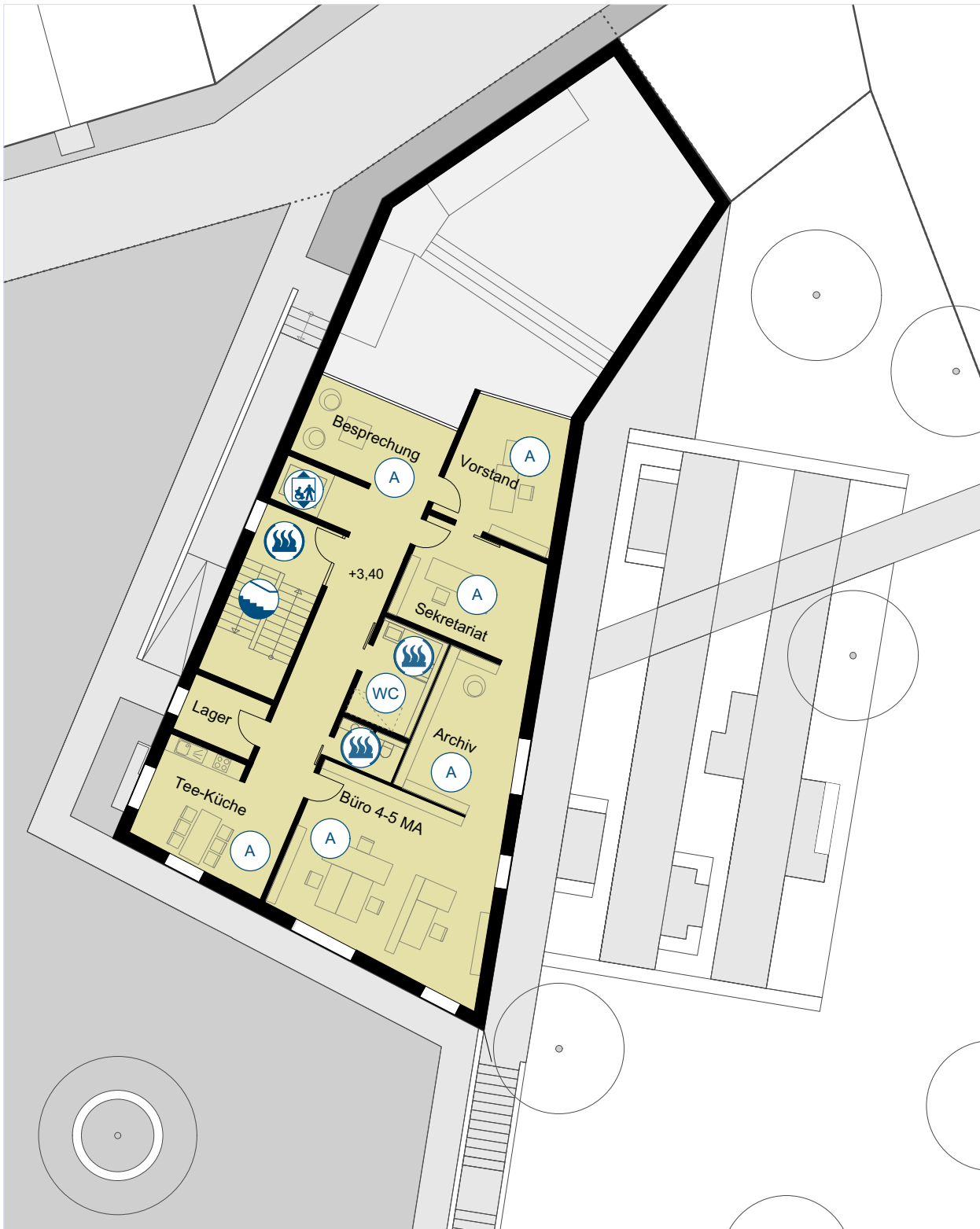
Grundriss Obergeschoss Konzept Barrierefreiheit M 1:200
